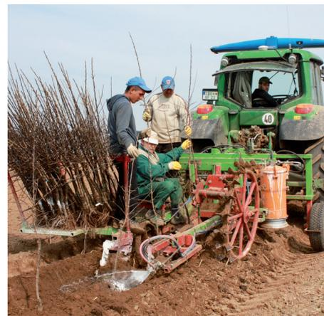
*Pflanzung von Bio-Tafelobstbäumen in Baderitz: Der Schlepper mit GPS zieht den Pflanzschlitten, an dem eine Farbspritze zur Markierung der Pfahlpositionen angebracht ist*
